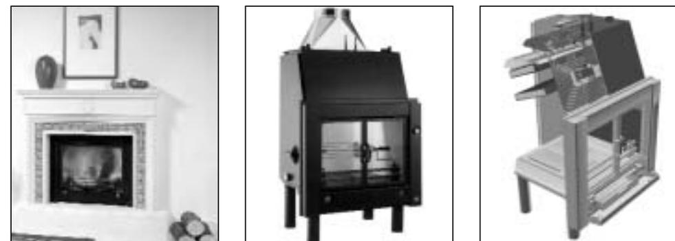
All'interno della camera di combustione possono essere alloggiati diversi elementi metallici cavi, attraversati dal fluido termovettore allo scopo di migliorare l'efficienza della macchina termica. La fiamma ed i fumi di evacuazione lambiscono questi elementi collettori riscaldando le pareti esterne e, conseguentemente, il liquido in movimento all'interno degli scambiatori. Il liquido è convogliato nell'impianto di riscaldamento a valle.
